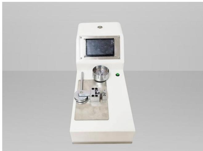
M TEST è uno strumento per effettuare prove di trazione su terminali elettrici aggraffati su cavi. È dotato di un visualizzatore digitale di picco e di una pagina riportante i valori di riferimento a seconda delle sezioni dei cavi. La versione M TEST P dà la possibilità, essendo associata a una piccola stampante, di stampare i dati relativi al test effettuato con logo, azienda e data.
