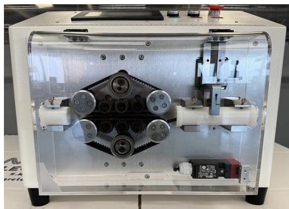
TSC TUBE L è una spezzonatrice studiata per tagliare a misura differenti tipologie di tubi in plastica, gomma, silicone, corrugati etc. con un diametro da 3 a 30 mm.
