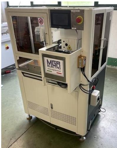
Le taglia spela e aggraffa CUBE sono delle attrezzature molto semplici nell'attrezzaggio e nella gestione per arrivare ad ottenere la crimpatura di contatti elettrici alle estremità di cavi unipolari. Permette il taglio e la spellatura di cavi unipolari da 0,5 a 2,5mmq e la crimpatura in automatico di puntalini preisolati sciolti (ferrule).
